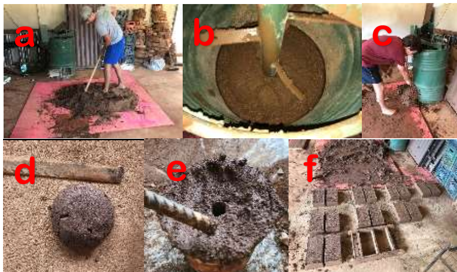
Solo corrigido + lodo de ETA (a), vista interna da “maromba” (b), massa de adobe homogeneizada (c), teste de “queda da bola” (d) e teste de Prueba de Vicat (e) e adobes enformados (f).
