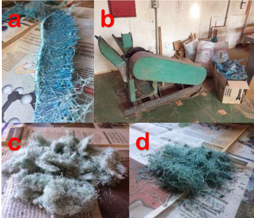
Figura 2. Processamento do resíduo de PRFV.
