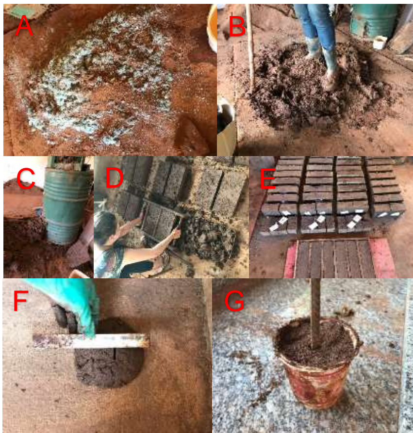
Figura 4. Etapas de produção e testes de umidade.
