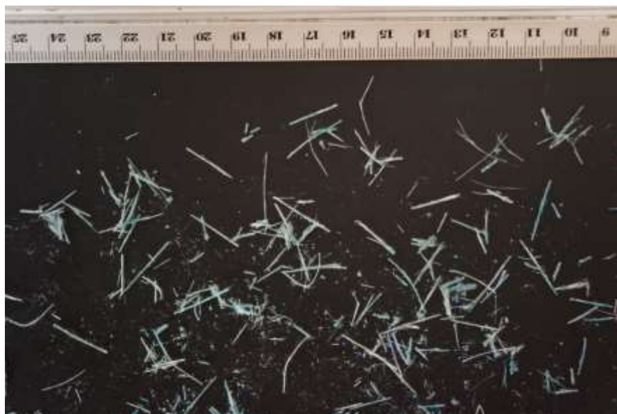
Figura 3. Partículas do resíduo de PRFV para análise de dimensão média.
