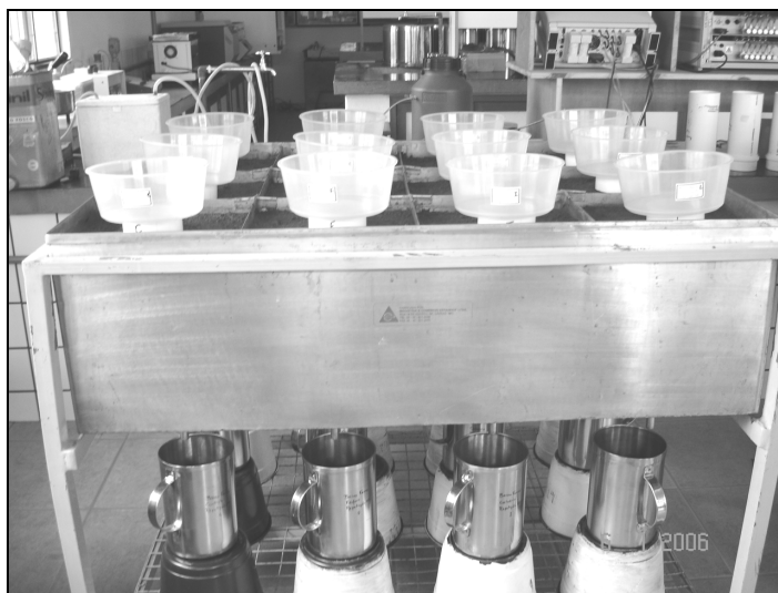
FIGURA 4. Vista geral do experimento com os recipientes plásticos em que a lâmina de água era colocada e os recipientes de aço inox para coleta do percolado.
