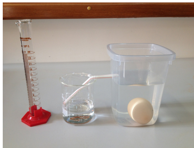
Figura 1. Determinação do volume real do ovo pelo método de imersão em água (Determining the actual egg volume by immersion in water).
