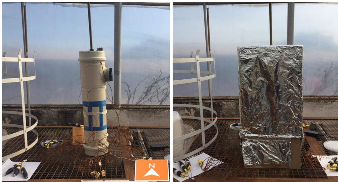
Figura 17 – Ensaio realizados em casa de vegetação. O protótipo foi posicionado com a janela apontando para o norte e se evidencia o uso da caixa refletora.
