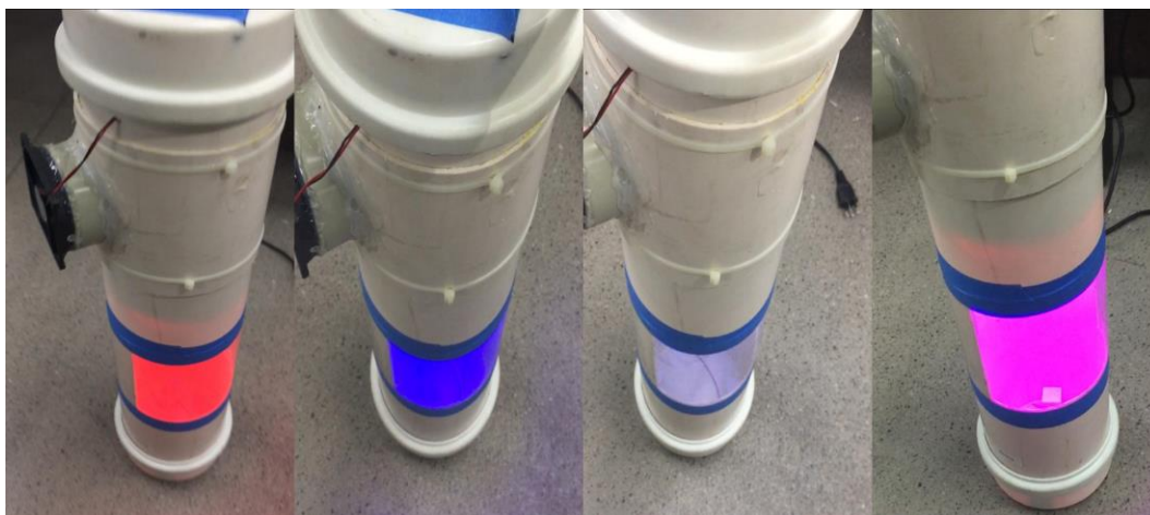
Figura 11 – Dispositivo mostrando diferentes composições luminosas: vermelho, azul, branco e rosa (soma das anteriores)
