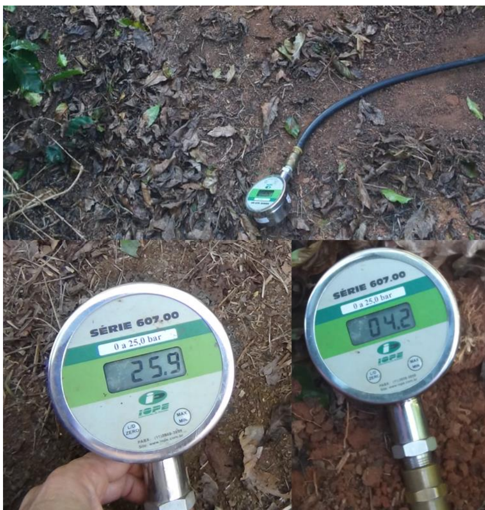
Figura 1 - Manômetro de pressão acoplado à mangueira (pressurômetro).
