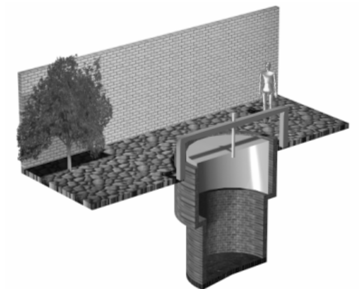
Figura 4 Esquema tridimensional de um biodigestor batelada.
