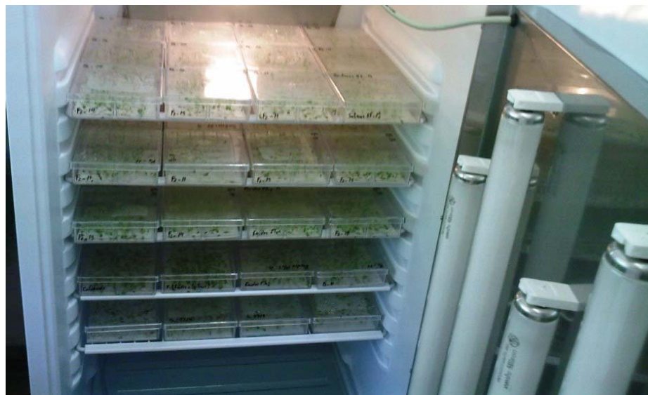
FIGURA 1B Câmara de germinação tipo BOD, com controladores de temperatura, fotoperíodo e umidade.
