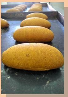
O resfriamento é a etapa que contribui para a estabilidade da estrutura do miolo. Essa etapa antecede as etapas de fatiamento e embalagem e, portanto, é importante por evitar a deformação do pão e uma possível contaminação por fungos filamentosos devido à condensação da água na embalagem. Esse processo pode ser feito expondo os pães à temperatura ambiente por 2 horas (Figura 8).
