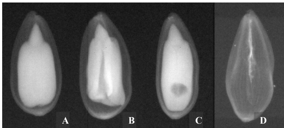
Figura 3 Imagens radiográficas de sementes de girassol quanto a morfologia interna em quatro categorias: A - Cheia, B - mal formada, C - com dano, D - Vazia. UFLA - Lavras, 2011
