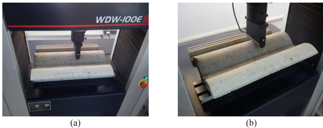
Figura 2. Teste de flexão de uma telha realizado na máquina universal de ensaios.
