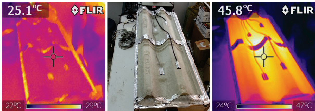
Figura 4. Imagem real e termográfica no início e final do período do experimento.
