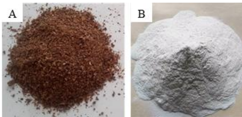
Figura 1: Matéria prima utilizada para produção dos compósitos. A) resíduo do cacau moído e peneirado e B) gesso fino comercial.
