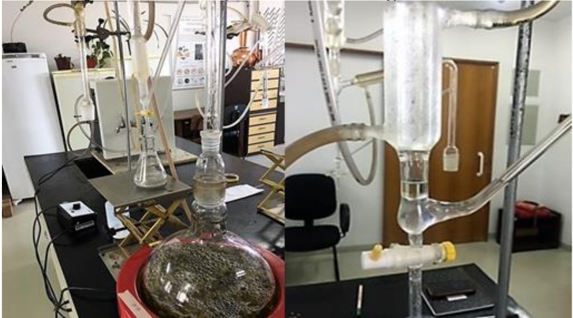
Figura 13 – Hidrodestilação do óleo essencial de Hyptis marrubioides
