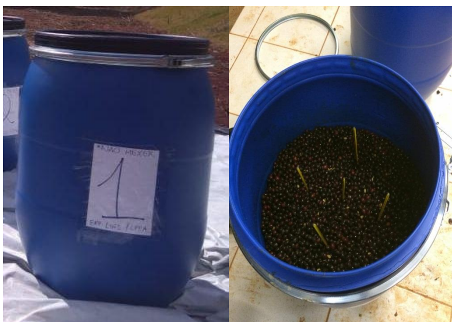
Figura 2: (A) Modelo de biorreator de poliestireno utilizado no experimento e (B) medição de temperatura.
