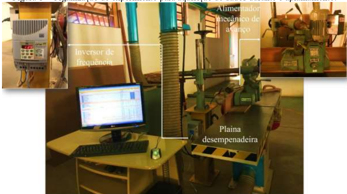
Figura 1 – Organização do experimento para aquisição de dados durante o aplainamento.
