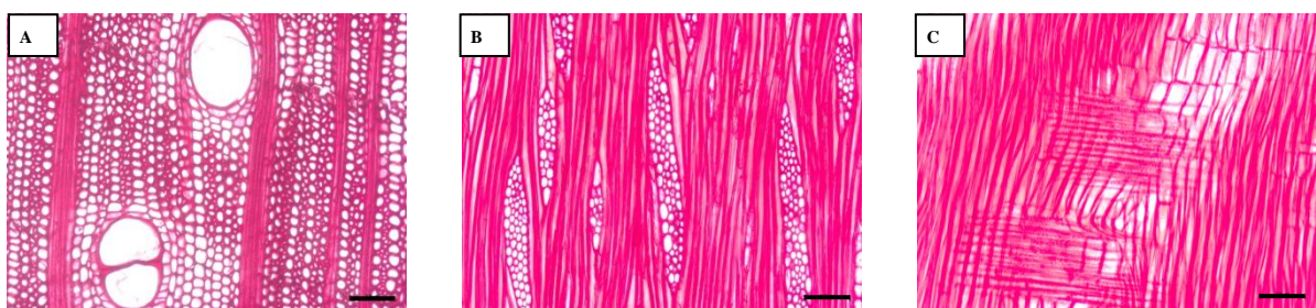
Figura 14 - Plano de corte transversal (A), tangencial (B) e radial (C) da madeira de Jaqueira na objetiva de 10x. Barras: 100 \mu m.
