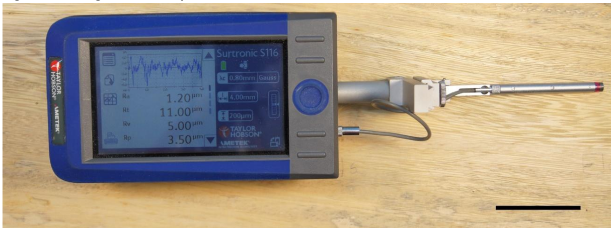
Figura 26 - Rugosímetro Taylor Hobson modelo Surtronic S116. Barra: 5 cm.
