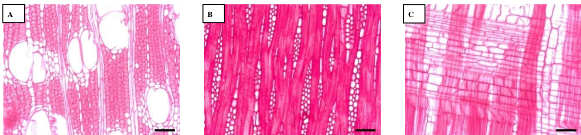
Figura 15 - Plano de corte transversal (A), tangencial (B) e radial (C) da madeira de Jamelão na objetiva de 10x. Barras: 100 \mu\text{m}
