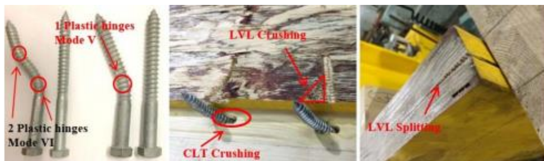
Figura 7: Modos de deformações nos pinos metálicos e falha da viga.
