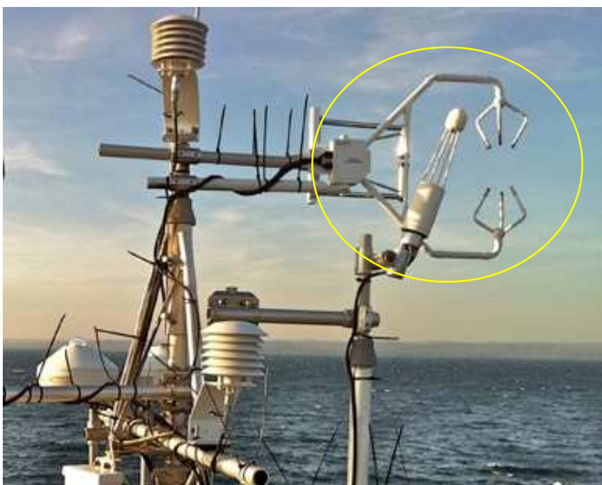
Figura 4: Estação Climatológica com detalhe dos equipamentos para medição de dados necessários ao método "Eddy Correlation" (BURBA, 2013)
