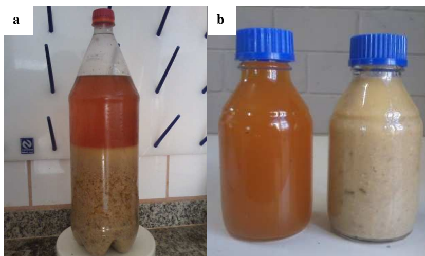
Figura 7 Fases da espuma separadas por gravidade no recipiente de coleta (a) e separação dos dois extratos para análises (b)
