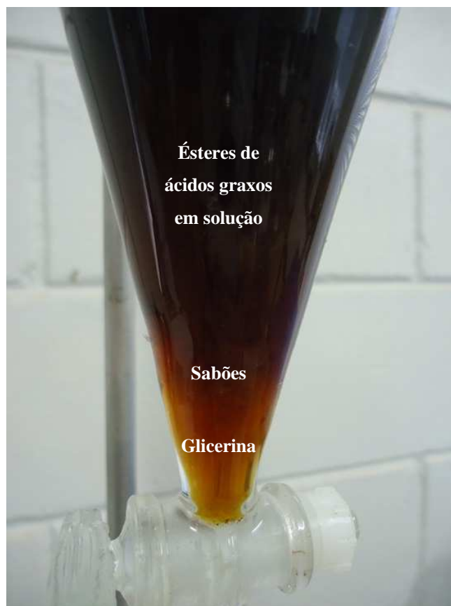
Figura 16 Separação das fases após transesterificação e presença de sabões na interface ésteres-glicerina
