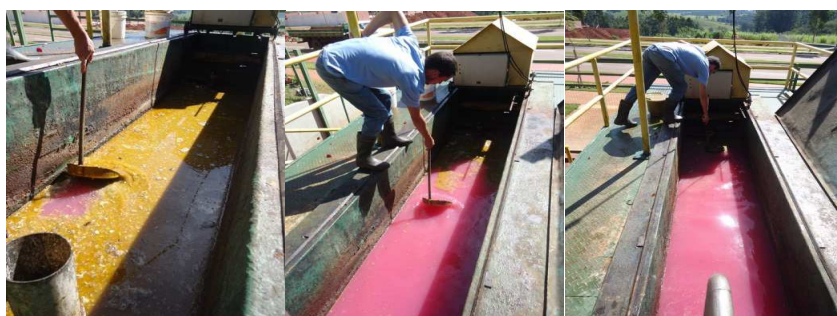
Figura 4 Procedimento da raspagem manual da espuma acumulada na CRG
