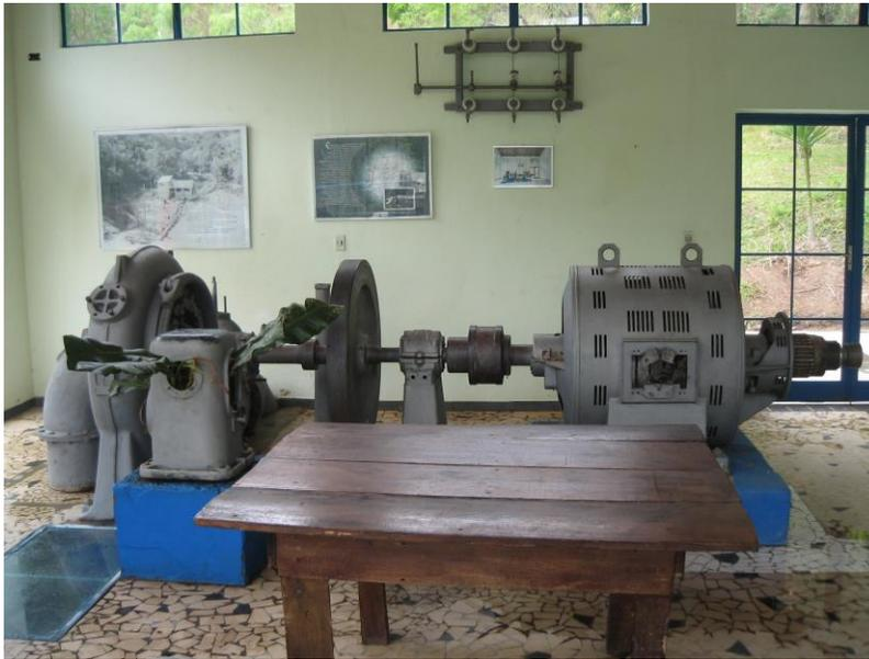
**Figura 9** – Turbina e gerador no interior da casa de máquinas. (Foto: José Carlos dos Santos)
