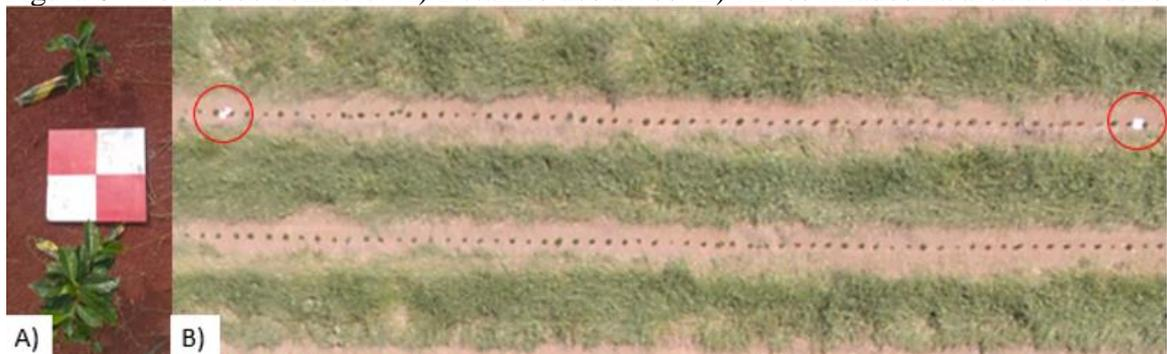
A calibração radiométrica do sensor ocorreu antes e após os voos, por meio da compensação precisa das condições de luz incidente e da geração de dados quantitativos, com auxílio de placa calibradora, sendo possível a captura das imagens conforme sobrevoo nas áreas de estudo, com horário padronizado entre 11:00 e 13:00 horas, possibilitando assim efeito comparativo entre imagens dos meses de estudo.
