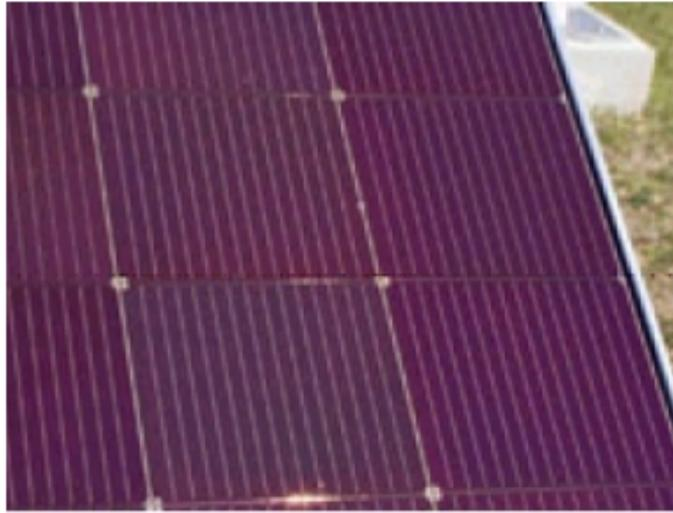
Figura 1.3 – Painel composto por células de silício amorfo
