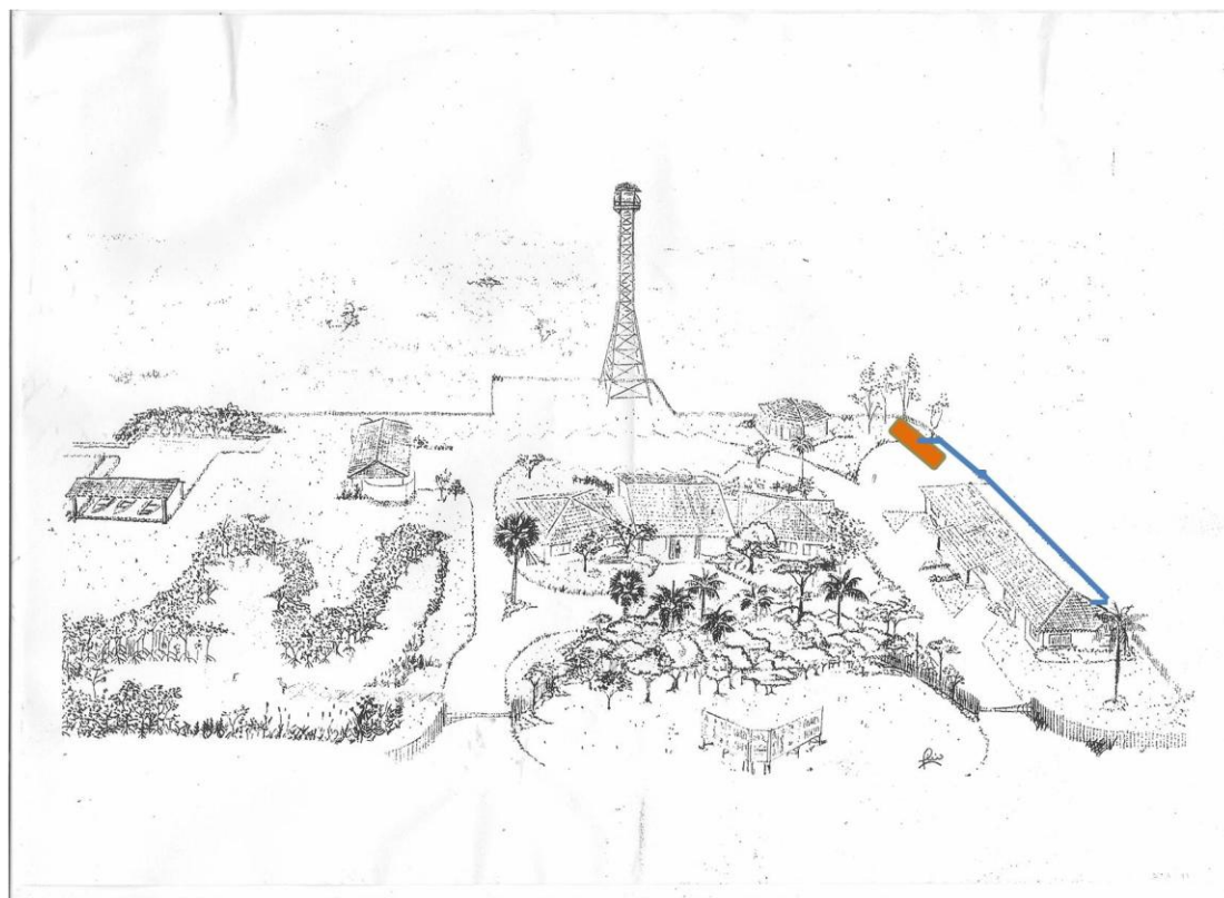
Figura 9 - Planta da sede mostrando local indicado para instalação do biodigestor e da tubulação para o biogás, do biodigestor até a cozinha. As tubulações para os efluentes sanitários deverão ser enterradas, portanto não são mostradas na figura
