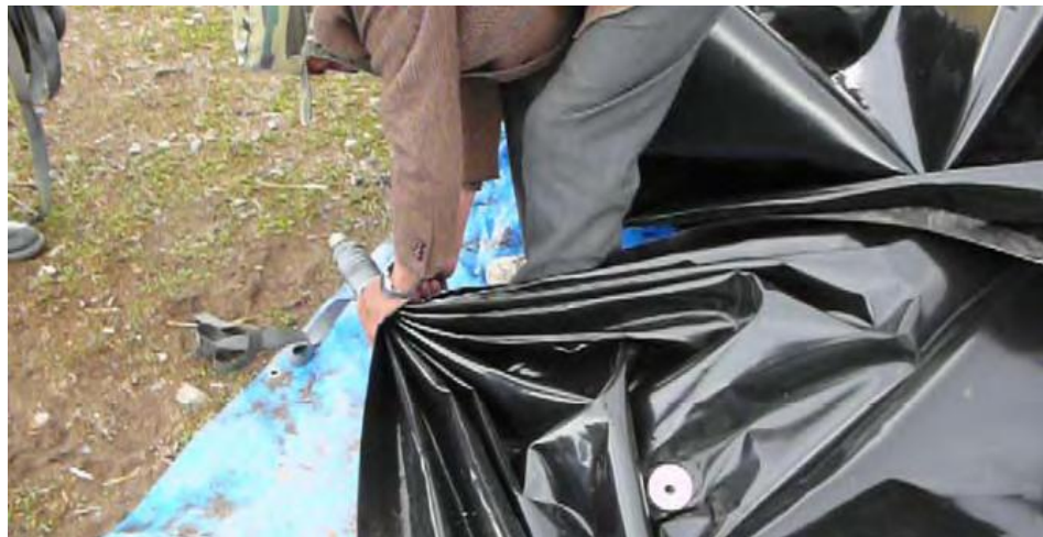
Amarram-se os lados selados, pregando-os em forma de acordeon contra um objeto oco para que se possa passar uma corda e prender o reservatório ao teto
