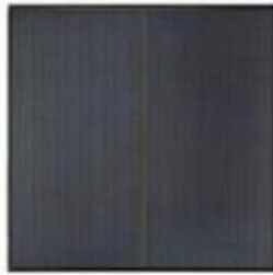
Figura 13 – Célula de silício amorfo Fonte: CRESESB, 2009.
