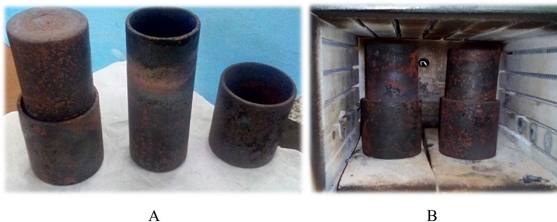
Figura 3 - Cilindros de aço (A) adaptados em forno do tipo mufla (B).
