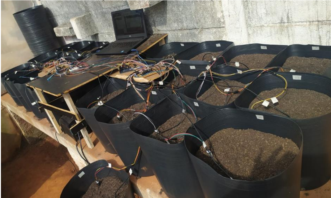
Figura 6 – Calibração de sensores com utilização do sistema arduino.
