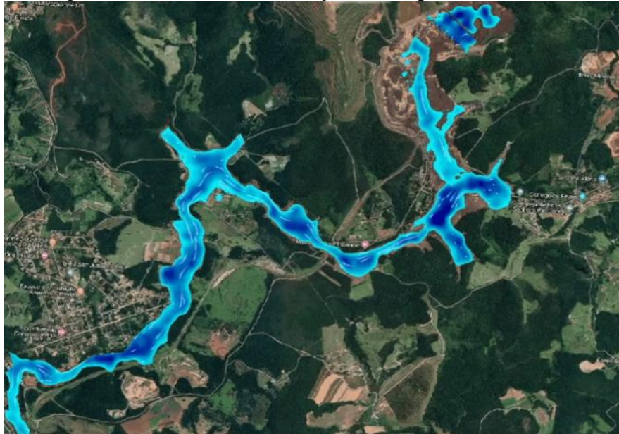
Figura 54 - Mancha de inundação obtida por Ramam e Liu.
