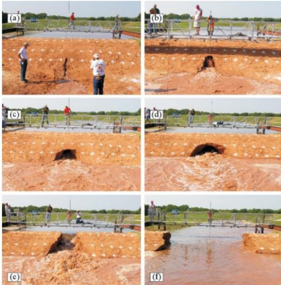
Figura 11 - Falha por erosão interna.
