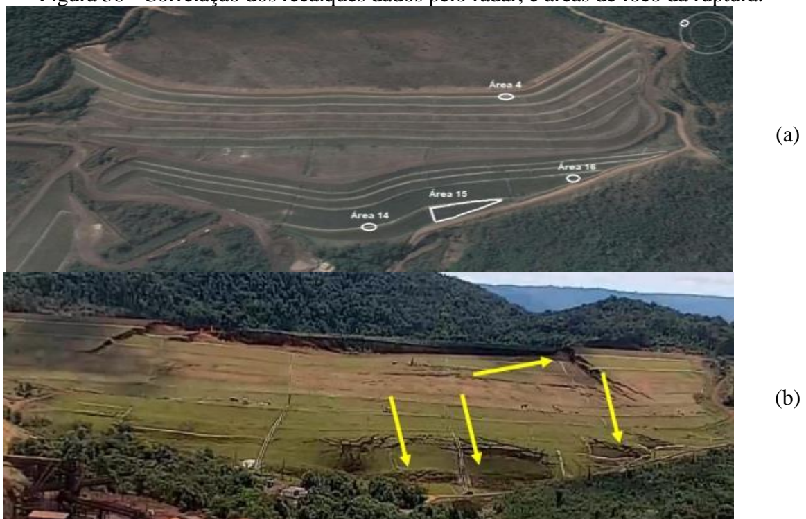
Figura 36 - Correlação dos recalques dados pelo radar, e áreas de foco da ruptura.
