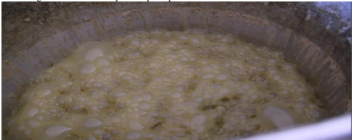
Figura 7 – Transformação do açúcar presente no caldo em CO 2 e etanol.
