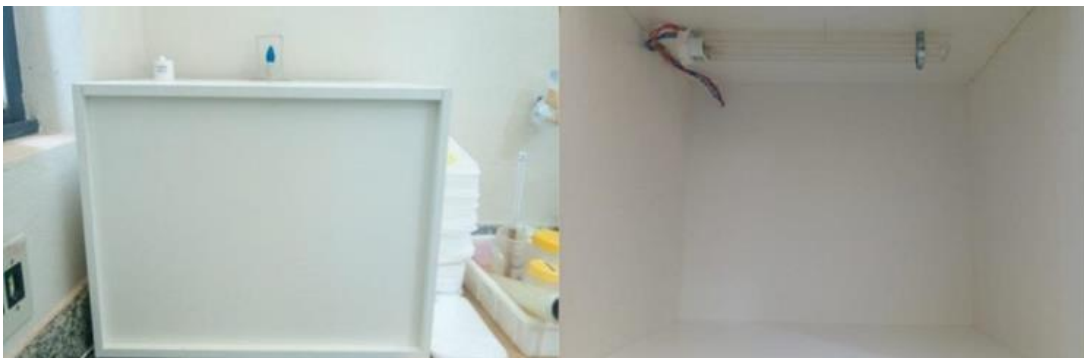
Figura 3.1 - Fotos (externa e interna) da câmara de irradiação UV-C utilizada no experimento.
