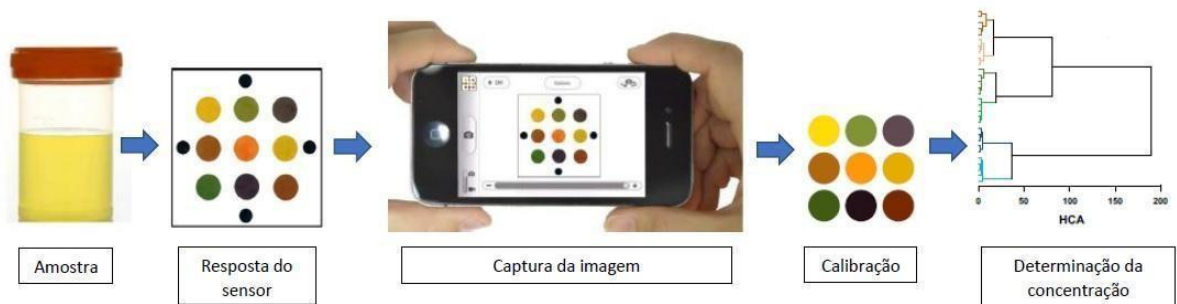
Figura 4 - Esquema de determinação de glicose em urina utilizando um smartphone para captura de imagem de sensores colorimétricos.
