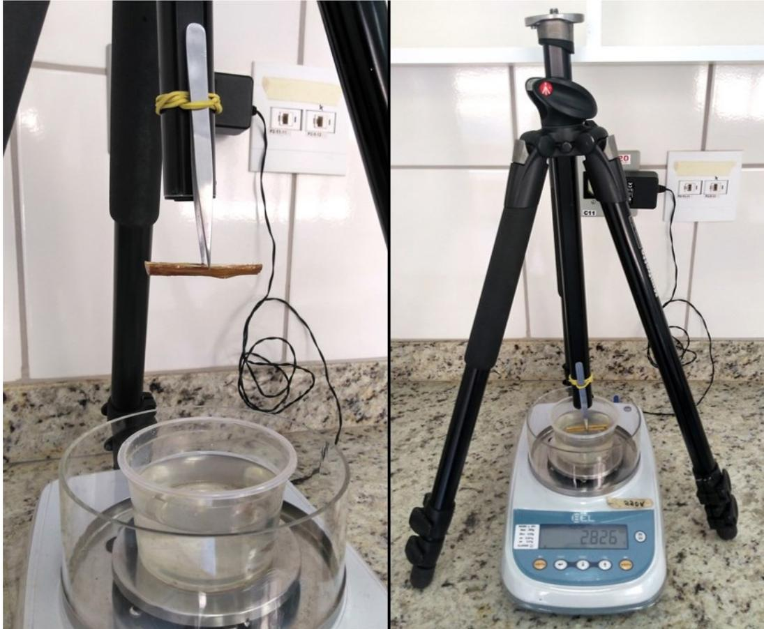
**Figura 3.4.** Medição do volume segundo o Princípio de Arquimedes, com auxílio de um tripé para câmera fotográfica e uma pinça de ponta fina, podendo também ser utilizada uma agulha (quanto mais fino o material, menor a interferência no volume final). A balança é tarada com o recipiente com água, e com auxílio da pinça amarrada ao tripé, a amostra de galho é submersa na água, de maneira que ela fique totalmente submersa, sem tocar em nenhuma das bordas do recipiente.
