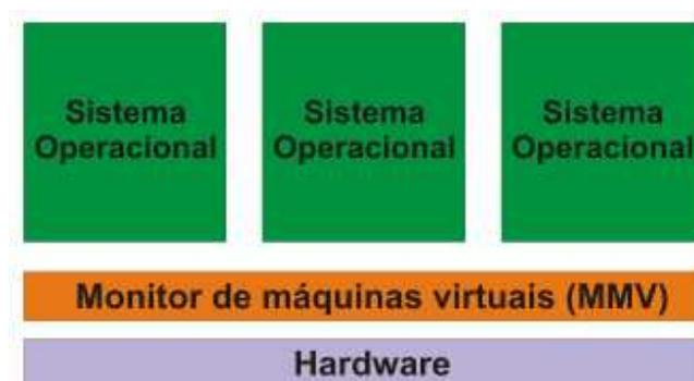
Figura 2.1: Estrutura de um sistema virtualizado.
