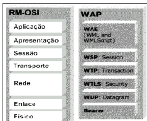
Figura 2 Comparativo entre o modelo OSI e o protocolo WAP
