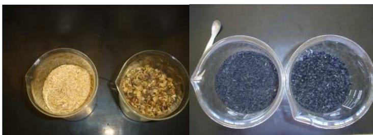
Figura 2 Carvão ativado granulado obtido da biomassa de palha de arroz e a casca de café
