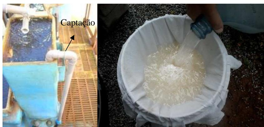
Figura 3 Pontos de tomada de água na ETA/UFLA para alimentação da ETAc e filtragem do coagulante preparado com semente de *M. oleifera*
