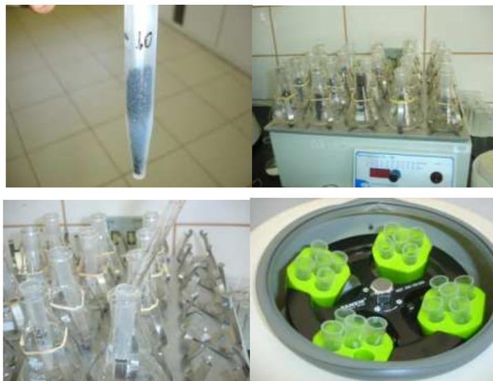
Figura 4 Sequência do ensaio de sorção do carvão ativado
