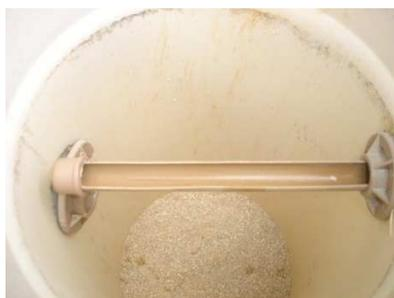
Figura 9 Recolhimento da água de retrolavagem no filtro multicamadas
