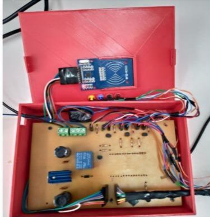
Figura 8 - Caixa do módulo de controle interno aberta
