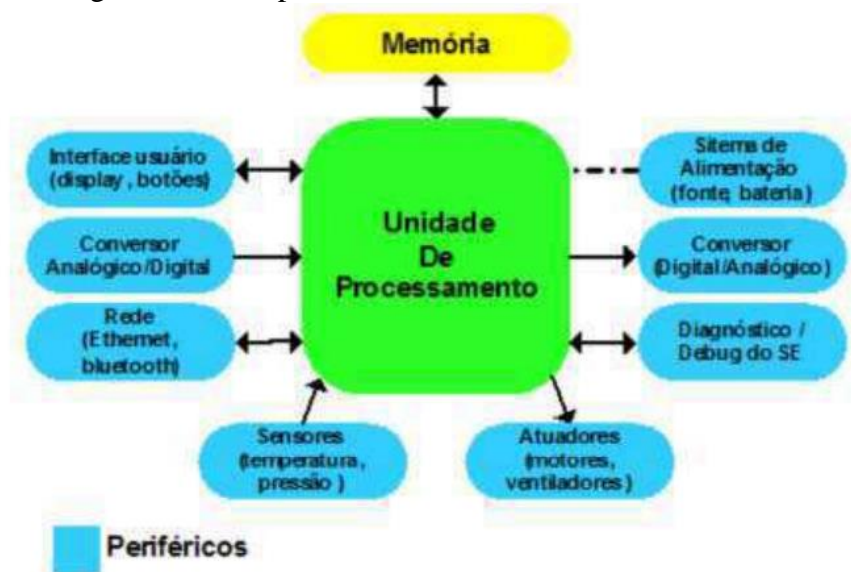
Figura 3 – Exemplo da subdivisão do modelo embarcado
