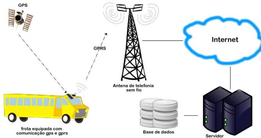
Figura 8 Arquitetura do Módulo Coletor
