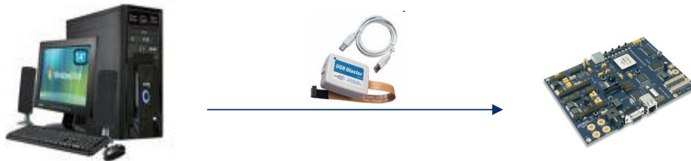
Figura 17 O kit de desenvolvimento da Altera se conecta ao PC por um cabo USB blaster.
