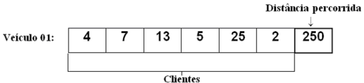
Figura 3.1: Representação de um veículo com a sua rota
