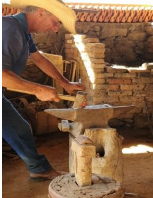
Figura 29: Fotografia – Sr. Zezito de Jesus forjando um prego para roda De Carro de boi usando bigorna e brasa de carvão.
