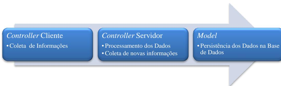
FIGURA 6.1 - ARQUITETURA MVC NO MECANISMO DE COLETA
