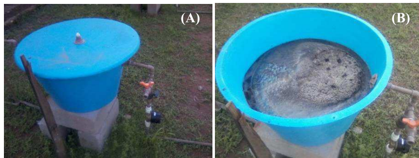
Figura 9 Reator anaeróbio vedado para reação anaeróbia (A) e reator anaeróbio destampado (B)
