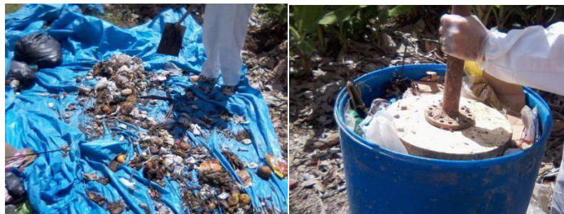
Figura 8 Mistura do resíduo sólido e compactação dos resíduos de acordo com as densidades
