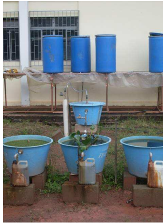
Figura 3 Experimento em campo com um conjunto dos três recipientes interligados a um reator anaeróbio de baixa carga e em seguida por três wetlands construídos
