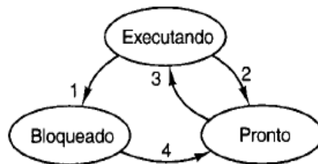
Figura 3.2 - Alternância de processos na CPU.
