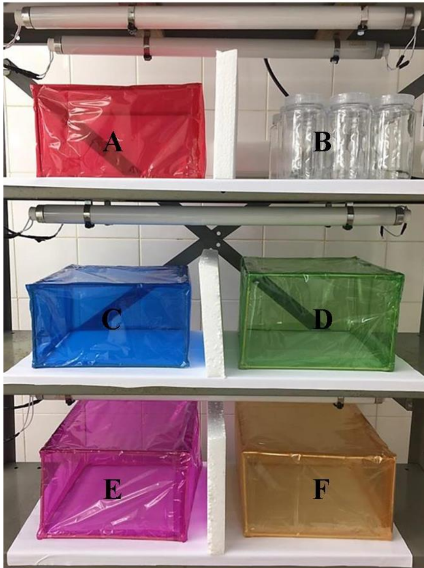
Figura 1 – Sistema utilizado para fornecer as qualidades espectrais no experimento, pela filtragem da saída de luz das lâmpadas fluorescentes por meio de folhas duplas de celofane. A: vermelho, B: branco (controle), C: azul, D: verde, E: roxo e F: amarelo.
