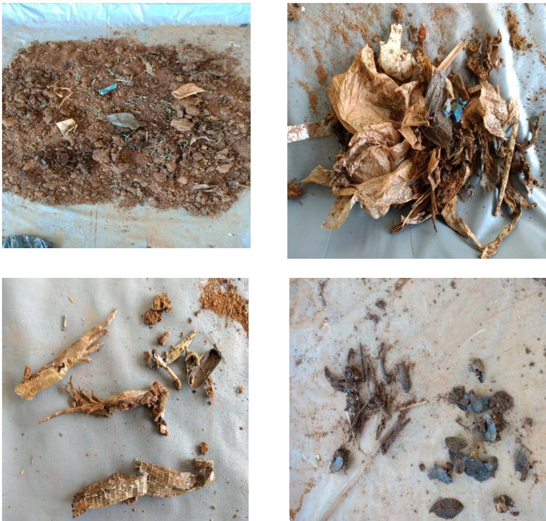
Figura 11 - Resíduos retidos no tratamento preliminar da ETE-UFLA, elevatória Veterinária.
