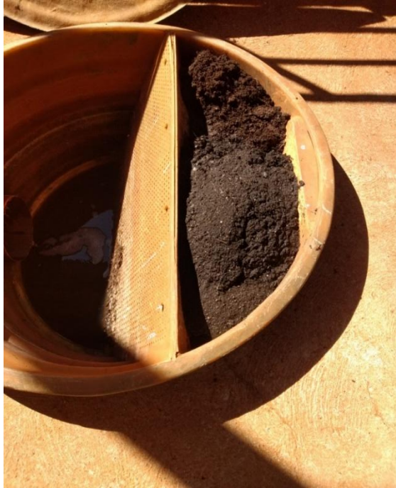
Figura 6 - Resíduos sólidos retirados dos gradeamentos.
