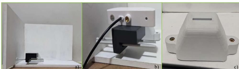
Figura 2. (a) Estrutura de simulação; (b) Suporte da câmera; (c) Suporte das peças.
