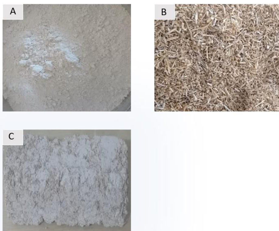
Fig. 1: Gesso fino comercial (a), partículas de jupati (b), compósito (c).
