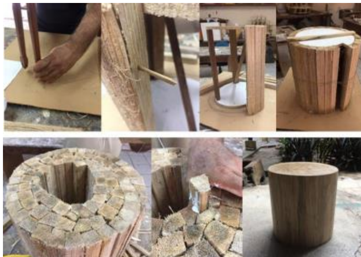
Figura 2 - Confeção dos bancos com pecíolo
