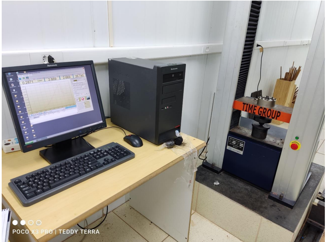
Figura 7. Determinação da resistência mecânica dos briquetes de acordo com a norma COPANT 466.
