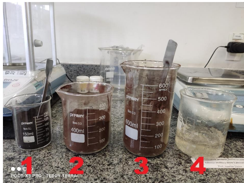
Figura 2. 1: Moinha de carvão vegetal, 2: Lignina Kraft, 3: Mistura pronta, 4: Carboximetilcelulose.
