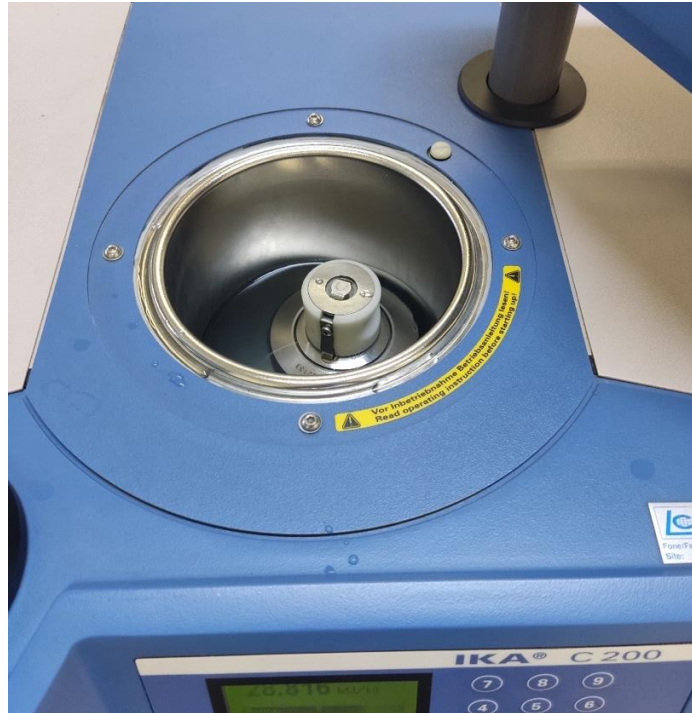
Figura 8. Determinação do poder calorífico superior de acordo com a norma NBR 8633.
