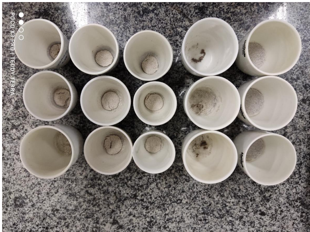
Figura 6. Determinação do teor de cinzas de acordo com a NBR8112.
