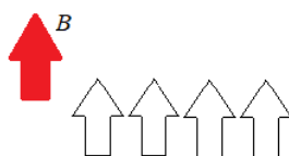
Figura 3.5 – Representação ilustrativa das orientações dos momentos magnéticos de dipolo magnético em um material paramagnético em relação a um campo magnético externo B .
