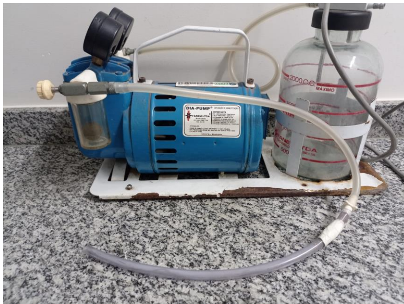
Figura 8 – Bomba à vácuo ou compressor adaptado para sugar insetos.
