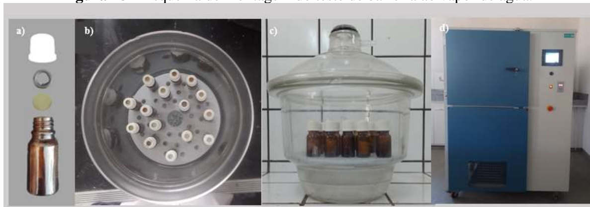
Figura 18 – Esquema de montagem do teste de barreira ao vapor de água.
