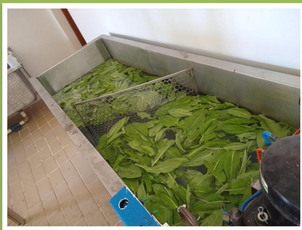
Figura 3 – Hidrorresfriamento da azedinha
